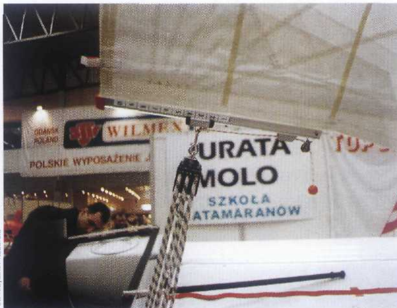
Szcątkowy bom pozwala zmieniać punkt zaczepienia szalów grota
