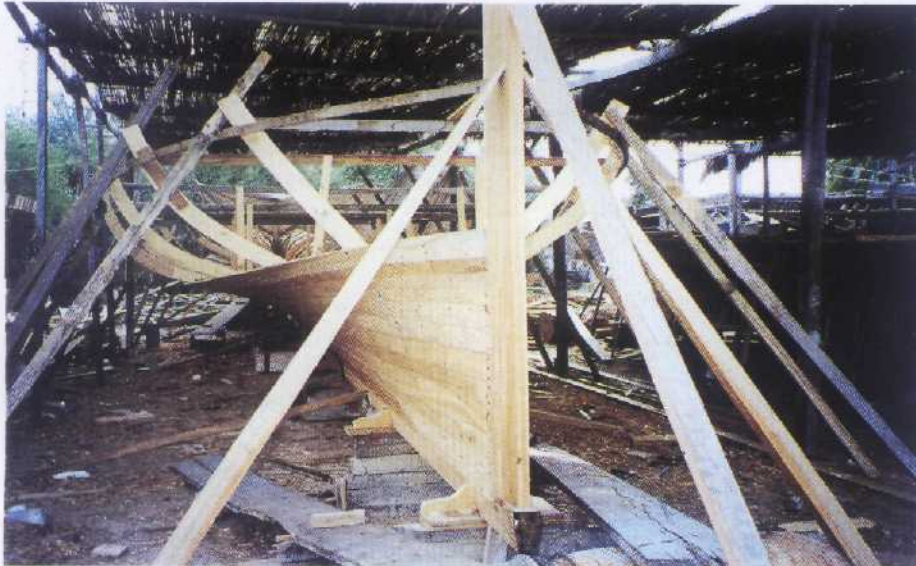
Budowa nowego dhou - doginanie klepek poszycia. Tradycja tradycją, ale elektronarzędzia i żywice epoksydowe są powszechnie używane
