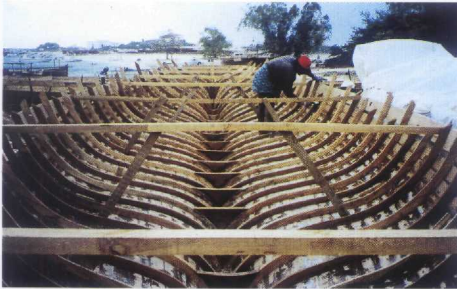
Poważny remont 20-metrowego kadłuba
