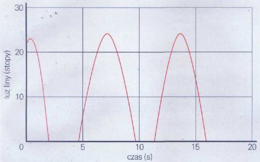
Rys. 2 Symulacja komputerowa zachowania liny dryfkotwy spadochronowej. Widoczne są cyklicznie pojawiające się szarpnięcia (luz liny = 0) oraz luzowania liny dryfkotwy. Do obliczeń przyjęto, że jacht o długości 30 stóp (9,1 m) wlecz dryfkotwę o średnicy 4 stóp (1,2 m). Długość fali, L-200 stóp (60 m), wysokość fali, H-20 stóp (6 m), źródło: USCG Report No. CG-D-20-87.
