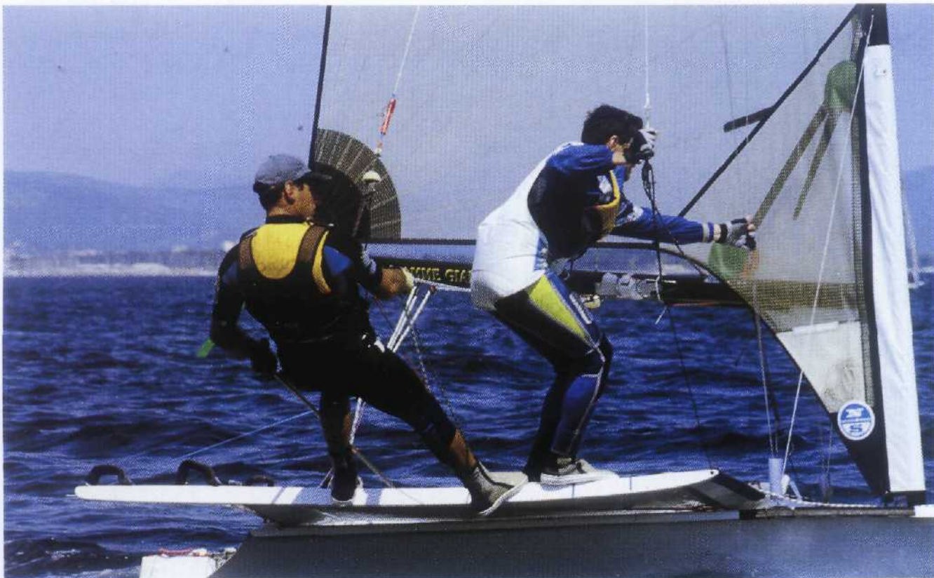
„Kieszon” żagla zasłania „siłownik” wypierający do dołu bom, który spełnia rolę obciążacza bomu. Szybrowa płetwa steru mocowana jest w opływowym, kompozytowym jarzmie
