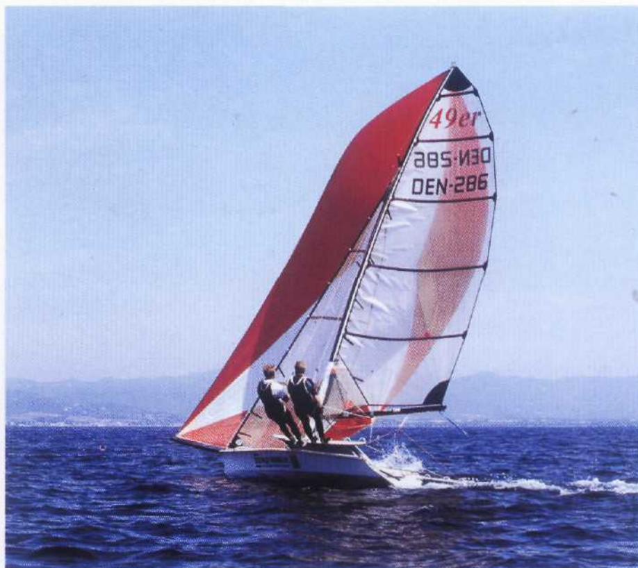
Ramę skrzydeł reguluje się w zależności od ciężaru załogi
