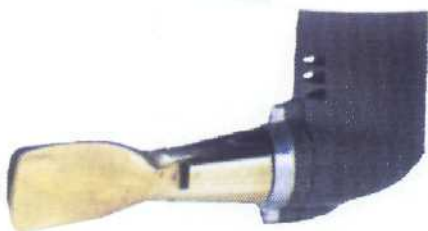
Fotografia przedstawia silnik z przekładnią typu „Z”
