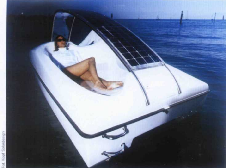
Solo 10: długość 3.95 m; szerokość 1.8 m, zanurzenie 0,3 m, masa 500 kg; załoga max. 5 osób
