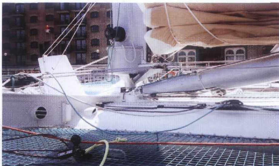
Obrotowy maszt-skrzydło mocowany jest na przegubie kulistym
