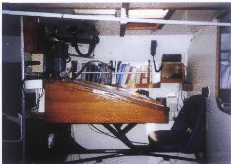
Wsparte na lekkiej kratownicy stanowisko nawigatora
