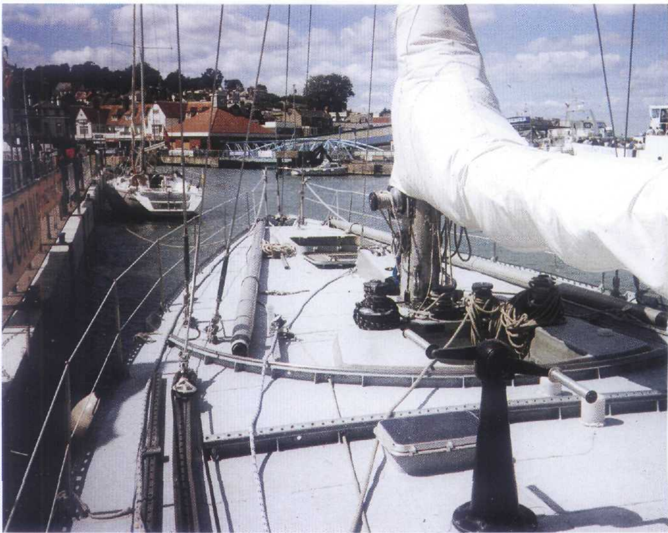
Charakterystyczna półkolistą prowadnica szotów grota na pokładzie PEN DUICKA VI
