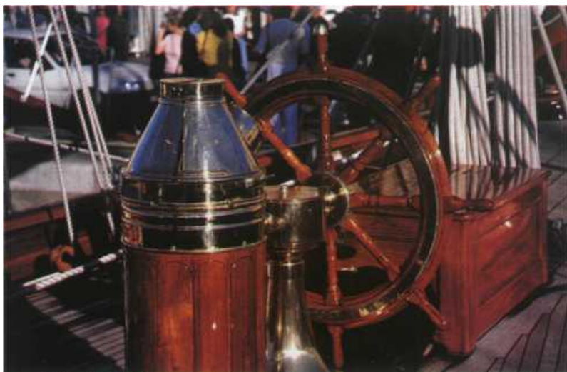
Kolo sterowe i kompas z naktuzem na jachcie ALTAIR
