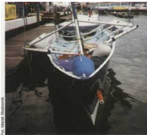
Charakterystyczne „balkony” skiffa ułatwiają balastowanie
