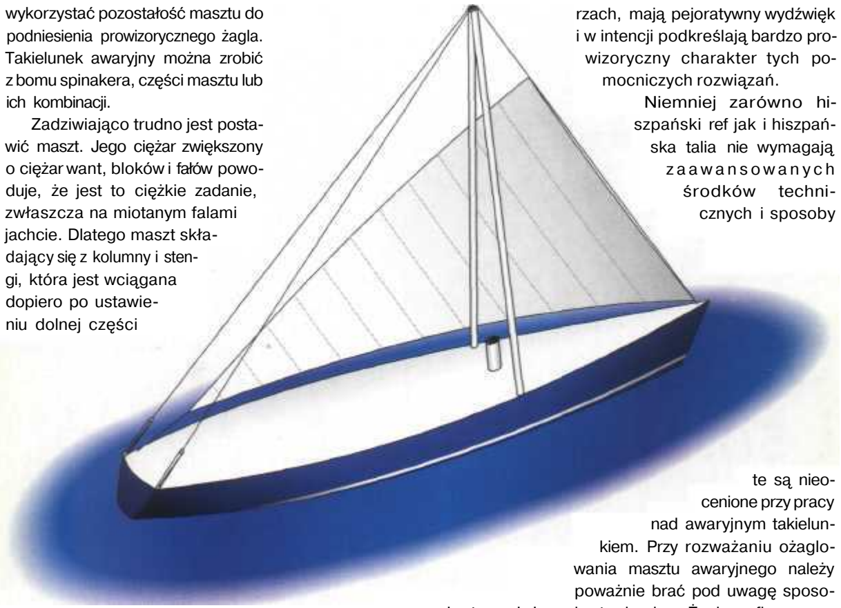
Dobrym rozwiązaniem jest maszt w kształcie odwróconej litery V
