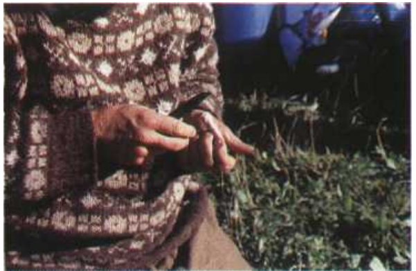
Wykonanie dwóch kołków z drewna wierzbowego. Na kołki używa się miękkiego drewna pęczniejącego pod wpływem wody. Kołek ma z jednej strony łeb, z drugiej strony wbity jest klin dębowy. Zasada twarde w miękkie. Kołki wbija się z przeciwnych stron.
