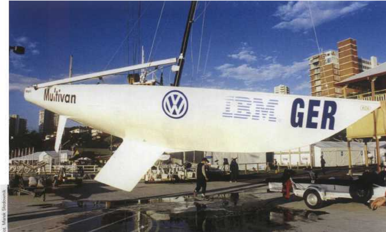
Soling to piękny kształt, a także perfekcyjne zrównoważenie środka boczno oporu i środka ożaglowania
