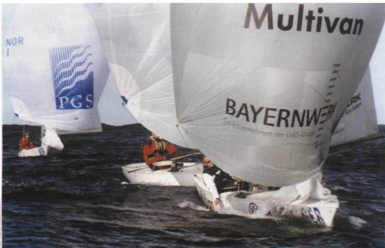
Na pełnych kursach Solingi żeglują z masztami przechylonymi do przodu o 30°
